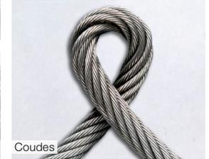
est également prête à être mise au rebut. Les photos de la page suivante montrent des exemples de critères de mise au rebut tels que le pliage, la fissuration, la rupture de fil, des défauts et la corrosion.
