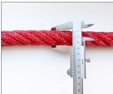
Illustration 9 : Pied à coulisse posé à plat pour déterminer correctement le diamètre du câble
